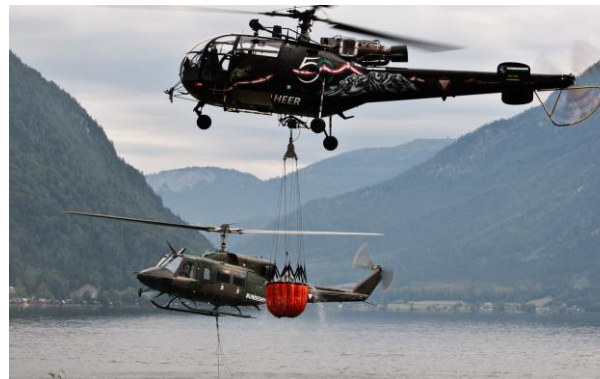
Abbildung 206: Im Vordergrund Alluette II und im Hintergrund Agusta Bell 1212 des Bundesheeres beim Wasserfassen. Aufnahme am 2. Tag. © Bild: WLV
