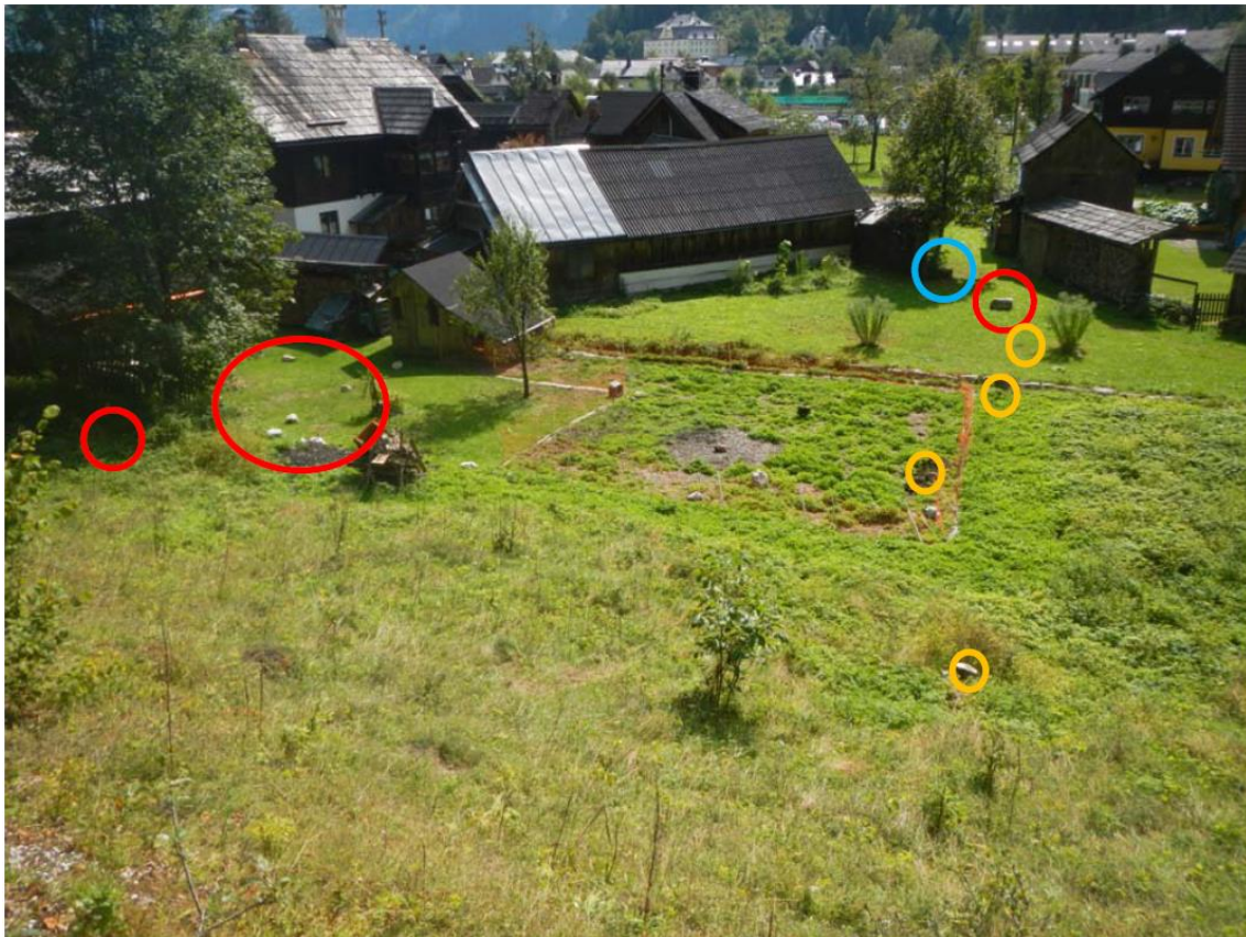
Abbildung 218: Reichweite der Steinschlagereignisse: alter Block (blauer Kreis), frische Blöcke (rote Kreise), orange Punkte rezente Schlagmarken © Bild: Melzner
